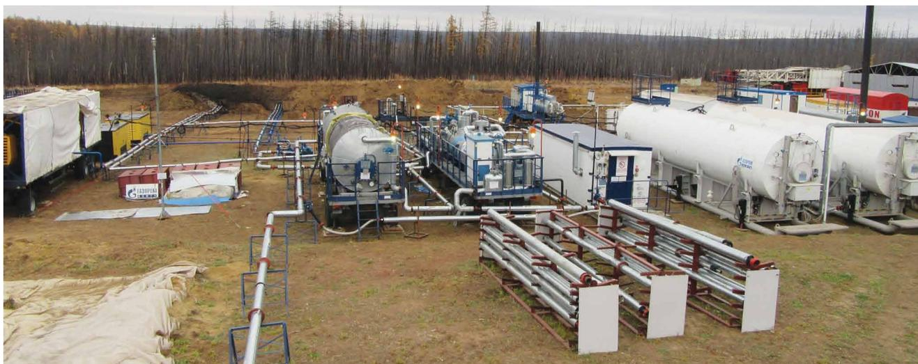
**В** подобных условиях возникает необходимость применения высокотехнологичного и, в тоже время, универсального оборудования, способного выполнять широкий спектр задач. С этой целью компанией Акционерное общество «МодульНефтеГазИнжиниринг» (АО «МНГИ») был разработан Мобильный измерительный комплекс для освоения нефтегазоконденсатных скважин (МИКОНС).
